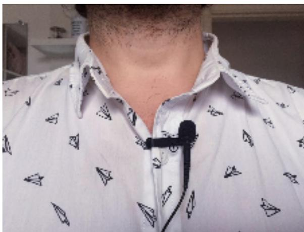
*Em geral os microfones lapelas são omnidirecionais - ou seja, eles captam som em todas as direções. Então não faz tanta diferença qual posição você coloca ele - e cada roupa vai permitir que você coloque ele de um jeito. Procure manter ele centralizado.*
